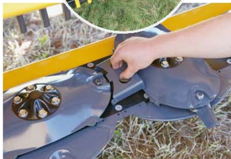
Lõikekettaid saab masinaga kaasas oleva filsaatori abil lukustada, nii et terade vahetus oleks lihtne ja turvaline.
