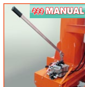
MANUAL Manual hydraulic pump for auger positioning Ручной гидравлический насос для позиционирования шнека
