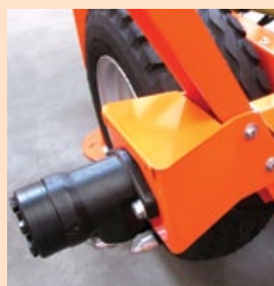
Hydraulic motor for recycling gate driving Гидравлический мотор заслонки рециркуляции
