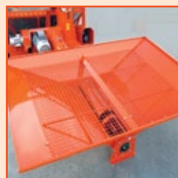
Loading hopper 2400 × 1500 mm for PRT200-250 Загрузочный бункер 2400 × 1500 мм для PRT200-250
