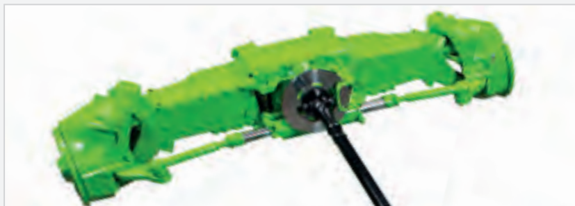
Kuivad ketaspidurid ja seisupidur
